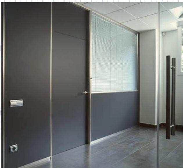
Tabique de 120 mm de espesor, formado por estructura oculta de aluminio extrusionado con burlete a bayoneta, que soporta 2 paneles de 16 mm de grosor, canteados y de montaje frontal separados entre sí por entrecalles de 3 mm, con remate a techo especial para soportar falso techo tegular, con cámara interior de 90 mm, para doble capa de lana mineral aislante de alta densidad y 40+40 mm de grosor.
